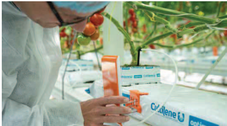
Ieder van de sensoren beschikt over vijf pinnen, die horizontaal in de mat steken.
