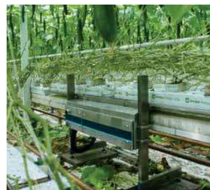
Het meetsysteem stuurt via de procescomputer de watergift aan.
